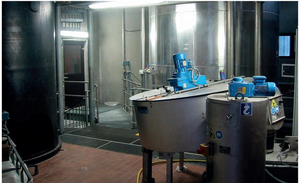
Ein bestehender Reaktor aus der früheren Schlammvorbereitung (im Hintergrund des Bildes sichtbar) wird zukünftig als Annahmespeicher für Fette von Fettabsepariern von Gasthäusern verwendet.
