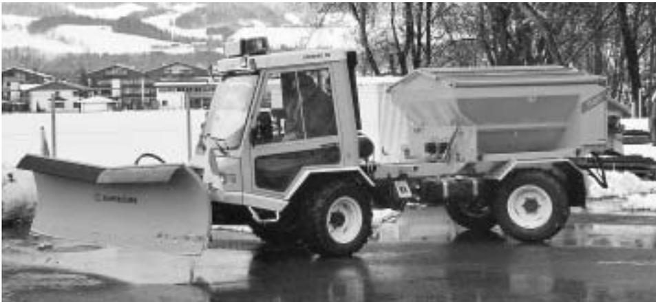
Diesem Schlepper bietet auch allenfalls später eine gute Möglichkeit zum Aufbau einer Schüttung, die für die Komposteinsammlung verwendet werden kann. Zudem ist mit diesem Fahrzeug eine ideale Kombination beim Winterdienst gegeben, nachdem damit gleichzeitig ein Schneepflug aber auch ein Streugerät, das sowohl Streusplitt als auch Salz mit sich führt, zum Einsatz gelangt.
